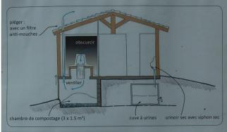
Directement reliées au composteur et ne nécessitant aucun ajout de sciure, ces toilettes fonctionnent sans eau de dilution ni de transport et sont associées à un processus de traitement par compostage. Dans ce bâtiment, la ventilation continue, grâce à un ventilateur, permet de gérer les odeurs. Les résidus sont stockés dans les chambres de compostage conçues à même le sol.
